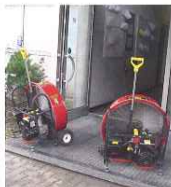
Effektiver ist der Einsatz der Lüfter, wenn sie parallel (nebeneinander) eingesetzt werden.
