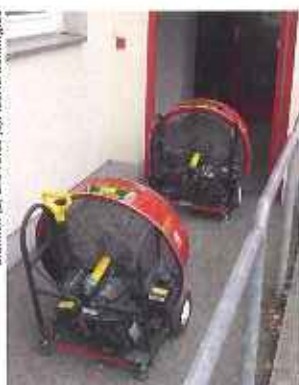
Bei beengten Platzverhältnissen können Lüfter in Reihe gestellt werden.
