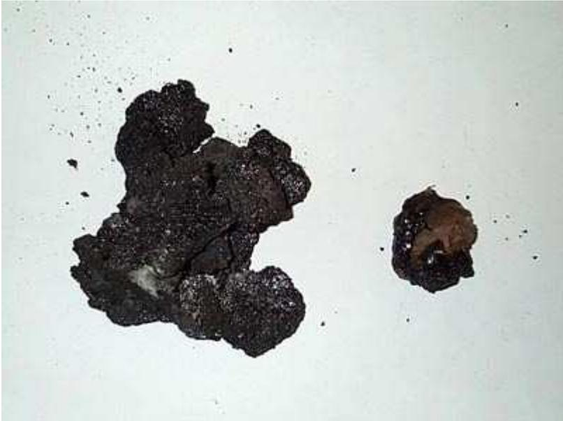
Bild 10 Die rechte Menge Glanzruß ergibt die linke Menge aufgeblähten und verbrannten Russ.
